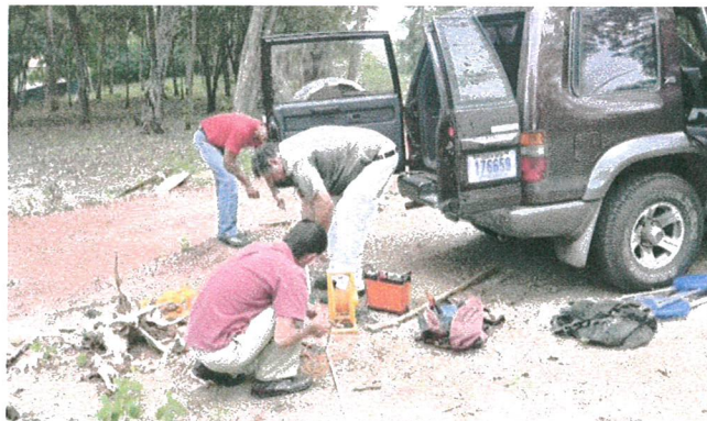
Figura 5.1: Sondeos Eléctricos Verticales SEV, realizado en la propiedad, por GEOSTRATU Consultores S.A.
